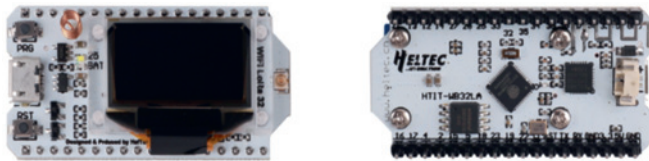
Bild 11: Heltec ESP32 LoRa V.2 Modul Vorder- und Rückseite (Quelle: [BildHeltecs])
