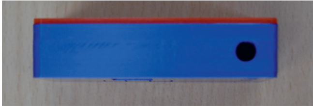
Bild 15: Bodendeckel und Oberschale sind nun zu einem Gehäuse verbunden.
