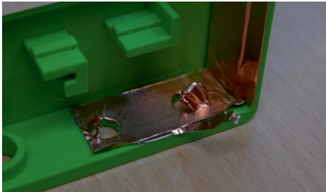
Bild 19: Korrekturschneiden des Folienstreifens.
