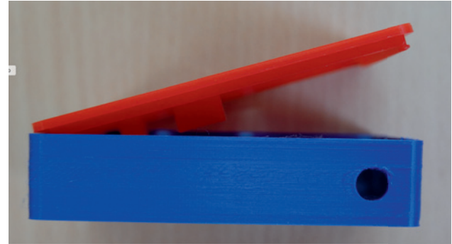
Bild 14: Der Bodendeckel rastet zum ersten Mal ein.
